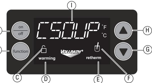
**A** Botón de encendido/apagado (ON/OFF). Púlselo para encender el equipo.
